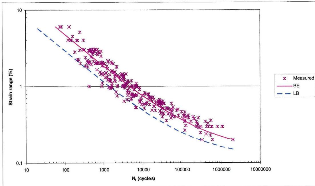
FIGURE 9.1 FATIGUE ENDURANCE OF C/C-Mn STEEL (RT-400°C).
